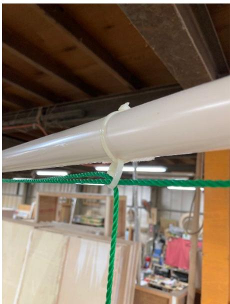
同じく結束バンドのリングにひもを通します。センターゾーンでは、1本のイレクターパイプに4つのフールツが吊るされますが、中央より左右にわけて2つずつひもをまとめます。
