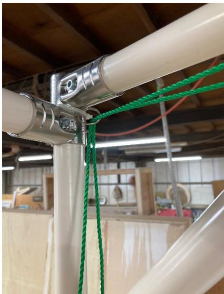
イレクターパイプのコーナーに金属のリングを固定、2本のひもを通し、ひもは下部のイレクターパイプに結んで固定します。
