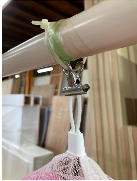
結束バンドを目玉クリップの両穴にとおしてイレクターパイプに固定、その上からテープで補強します。
