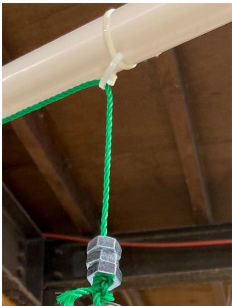
イレクターパイプに結束バンドを固定、テープで補強します。
